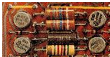
Fyra transistorer och några motstånd.
